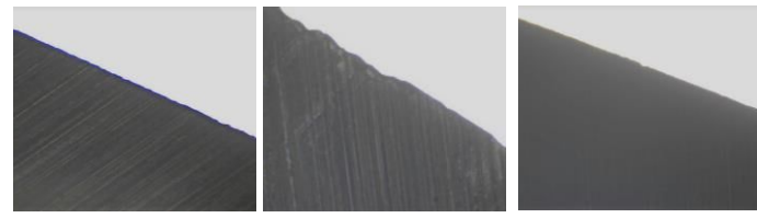
図3 実験で使用したハサミ（左から新品、空気中、水中でそれぞれ20回ずつ使用したもの）
