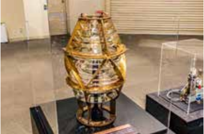
海上交通関連資料：大下島アゴノ鼻灯台で平成26年7月にLED灯に更新されるまで使用された灯器
