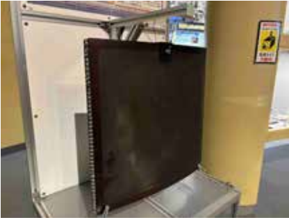
国産ロケットM-V試験機のフェアリングカットサンプル
