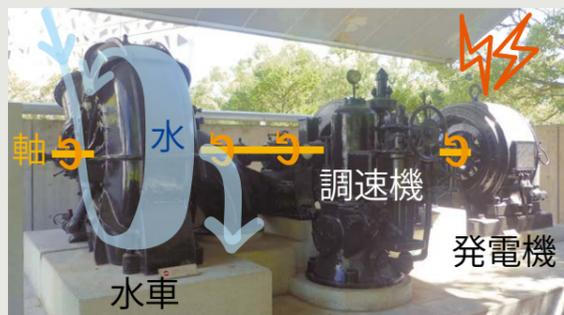
水車はドイツのフォイト社製、横軸単輪単流渦巻型フランシス水車。発電機はドイツのアルゲマイネ社製、三相交流横軸回転界磁型発電機です。当時の世界最高水準である260kWの発電能力がありました。1957(昭和32)年の湯山第一発電所廃止まで使用され、その後長年保管されていましたが、1994(平成6)年当館に移設されました。湯山第一発電所のあった場所には、現在ホテル奥道後壺湯の守が建っています。
