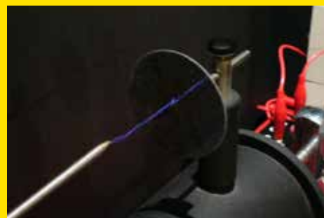
誘導コイル実験装置による放電現象
