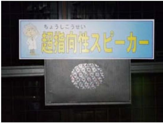
3階科学技術館ののぞけるホログラム「バードウォッチング」付近の頭上に、超指向性スピーカーを設置しました。鳥のさえずりを聞くことができ、鳥がすぐ近くにいるかのような感覚になります。超指向性スピーカーから聞こえる音（超音波）を、板で反射させてみましょう。
