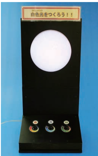
写真10 赤、青、緑のLEDで白色を作る実験装置 赤色、青色、緑色のLEDを下にある可変抵抗器で調節すると白色光が作れる実験装置を製作した。
