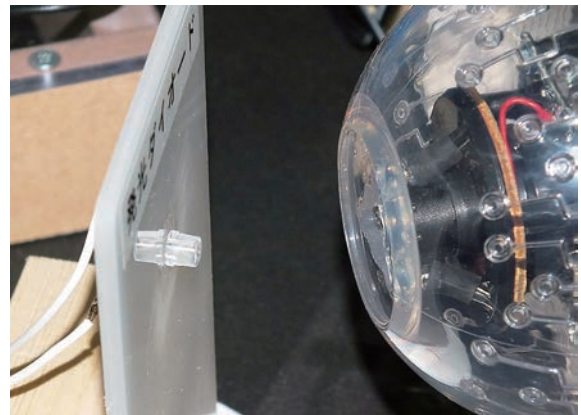
写真9 発光ダイオード（LED）電球の実験装置の拡大 立体的に見せるため、少し斜めの角度にCCDをセットし、拡大した映像を映し出した。
