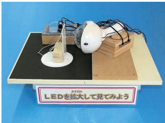
写真8 発光ダイオード（LED）電球の発光実験 砲弾型LEDを点灯し、点灯している部分をCCDカメラで拡大してディスプレイに映し観察した。
