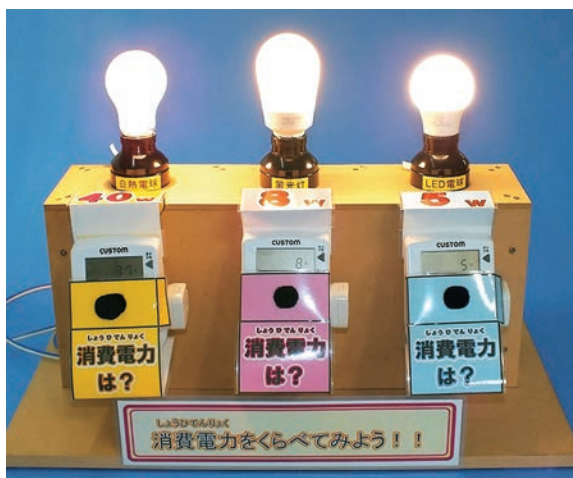
写真 14 白熱電球・蛍光灯・LED 電球「消費電力実験」 同じ明るさ（40W 相当）の電球を点灯し、それぞれの消費電力をエコキーパーで測定し、消費電力の違いを実験した。
