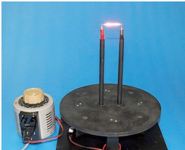
写真3 シャーペンの芯の発光実験 シャーペンの芯（2B）に電流を流し、発光する様子を観察した。
