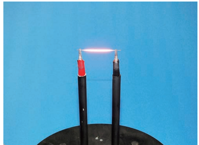
写真4 シャーペンの芯の発光拡大 はじめ煙が発生し、オレンジ色に発光、しばらくすると発光が小さくなり、切れる。
