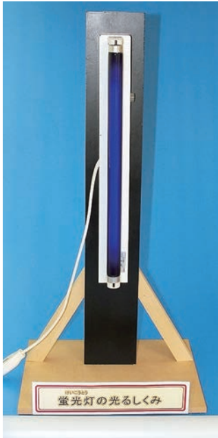
写真5 蛍光灯の発光実験（蛍光シートをかぶせる前） 紫外線を出すブラックライトを点灯すると、暗い紺色に発光する。
