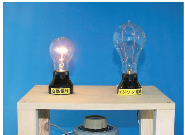
写真2 白熱電球の発光実験 昔の電球（エジソン電球）と今の白熱電球を可変抵抗器（スライダック）でゆるやかに電圧を上げ、フィラメントが発光していく様子を観察した。
