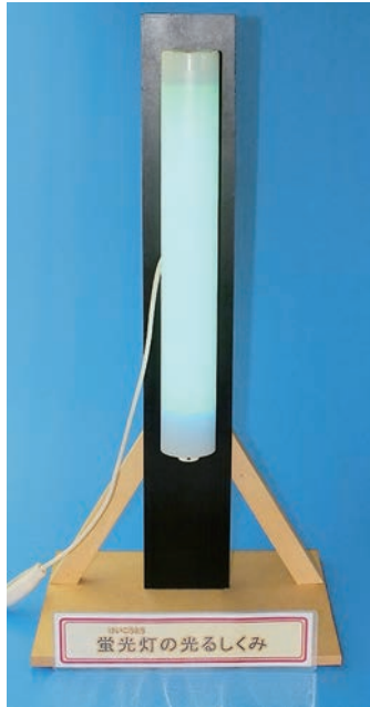
写真6 蛍光灯の発光実験（蛍光シートをかぶせた後） 蛍光シートを上にかぶせると、明るく発光する。
