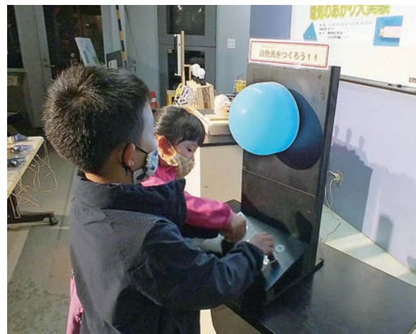
写真11 赤、青、緑のLEDでシアンを作る実験 赤色、青色、緑色のLEDを下にある可変抵抗器で調節しながらシアンの光を作る体験をしてもらった。
