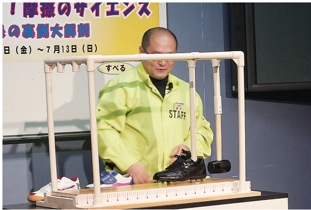
写真1 シューズ摩擦実験器 ゴムハンマーを振り下ろしてシューズを打ち出し、どの場所で止まるかを予想する。
