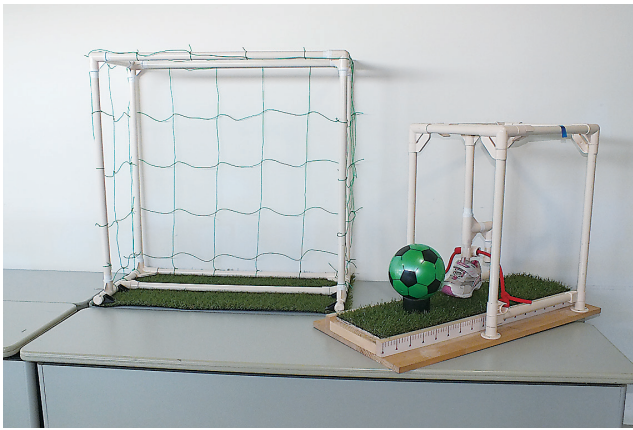
写真7 バナナシュート実験器 ゴムチューブの付いたシューズを引っ張り、その反動でボールを蹴る。左はミニゴールポスト。
