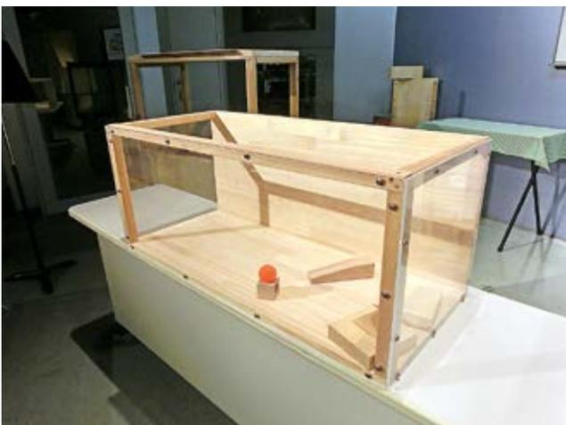
写真15 バウンドテスト。床面の段差などで思わぬ方向にバウンドすることを実験するための装置で、内部に入れた木切れに当てることで、急なバウンドの方向転回やスピード変化を見ることができる。
