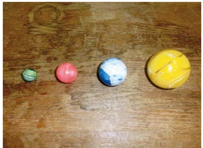
写真6 実験使用したスーパーボール. 22, 32, 45, 60mm φの4種類用意した. 模様は回転の視認性を上げるために, マーブル模様のものを主に使用した.
