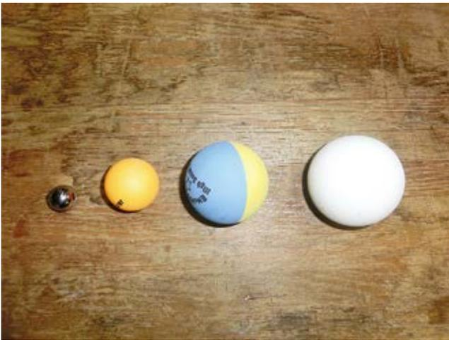
写真8 転がり競争や跳ね返り実験に使用した球。一様球として鉄球、空洞ボールとしてテニスボールとピンポン球を用意した。他に高反発ボールや実験用非弾性ボールなども用意した。
