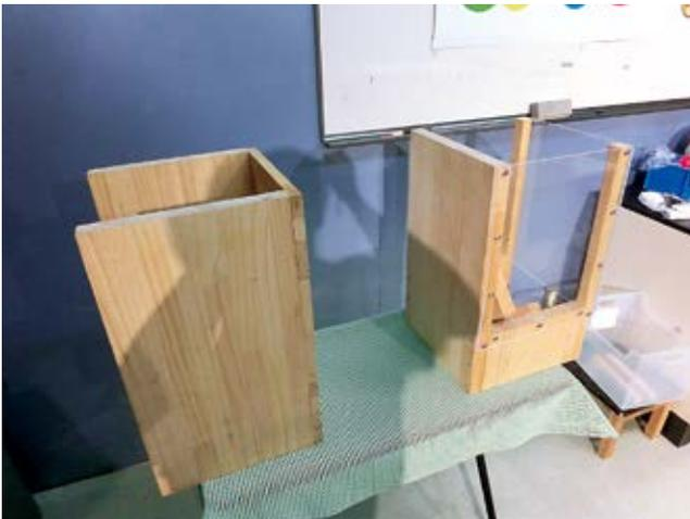
写真14 エントツ脱出実験セット。厚い集成材でできた壁を並べて実験するので、壁間の距離を調整することもできる。
