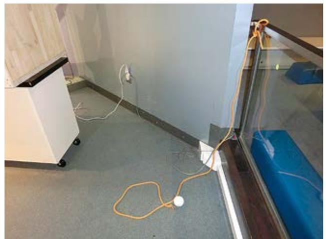
写真18 ゴムの弾性力実験。ストレッチ用のゴムにテニスボールを取付けたものの一端を柵にくくり付けて実験した。
