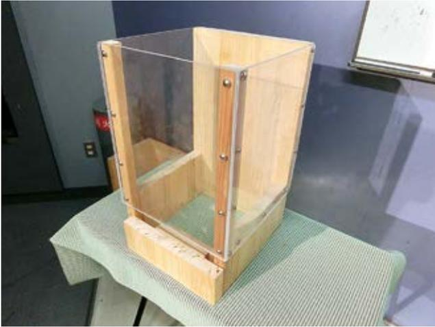
写真13 エントツ脱出用チャンネル（透明仕様） 煙突型にしているため立体的なエントツ反射を実験でき、バウンドの様子を観察で器量に透明アクリルで3面の壁としている。
