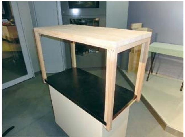
写真11 テーブル反射装置。実験ワゴンの上部にテーブルを設置してバウンドを見やすくしている。バウンドの安定のために天板は重く、死角を減らすために脚は細くしている。
