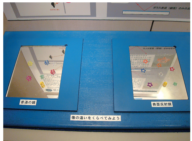
写真12 普通の鏡（左）と表面反射鏡（右）
