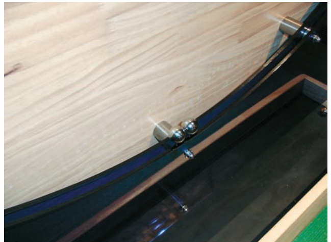
写真4 アクリル板によるサイクロイドコース. 19φの鉄球を使用. コースの左右で2球同時に手を離すと, 左右での高さの違いに関係なく必ず最下点で衝突する.
