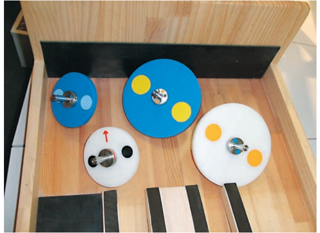
写真2 ころがりエネルギーで使用する回転体. 青い円板が軸に固定された回転体で, 白い板が軸に対して自由に回る回転体
