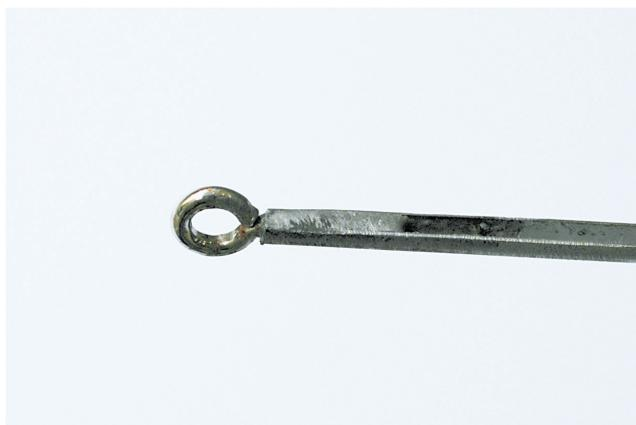
写真6 V字型の骨に直接ヒートンを溶接。
