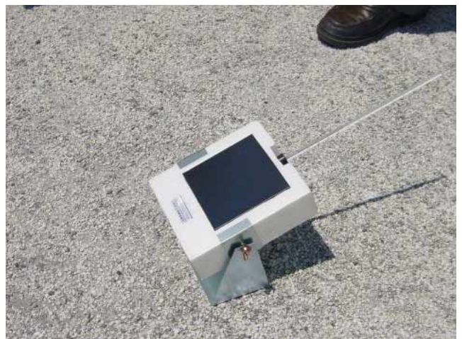
写真6 太陽放射エネルギー測定装置 受光面積が100cm 2 のKENIS(株)科学共栄社No142-855を使用。
