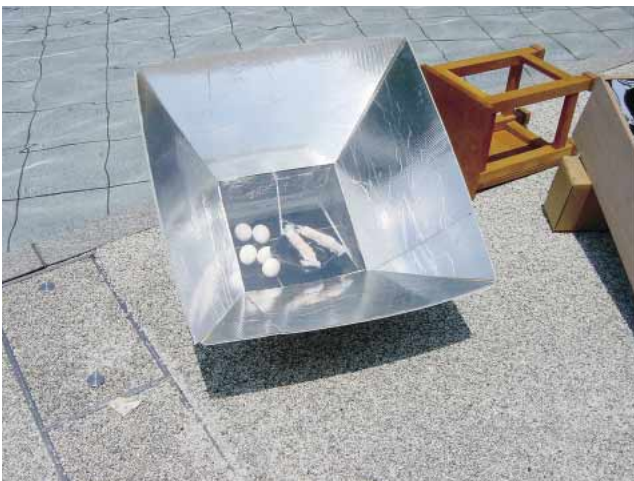
写真3 2001年8月4日 公開実験 熱箱型クッカー（太陽の光を断熱された容器に集め、容器内の温度を70～110程度に保ち調理を行う装置）によるゆで卵と焼き鳥の調理実験を行った。
