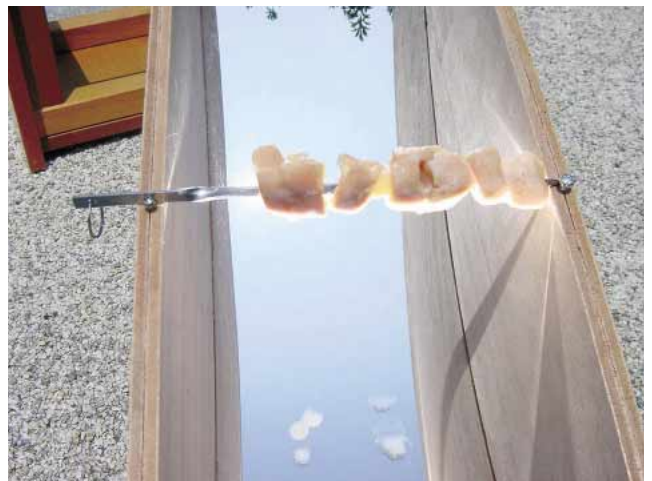
写真4 2001年8月4日 公開実験 焼き鳥クッカー（アクリルミラーを放物線状に曲げ太陽の光を直線上に集めて串に刺した食物を直接加熱調理する装置。精度が良く製作し易い。反射鏡面材料として選定したアクリルミラーは、ステンレス板に比べて反射率が高いため小型ながら高効率を得られる。反射鏡タイプ的一种。）による焼き鳥の調理実験を行った。
