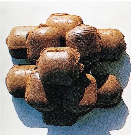
写真6 酸化亜鉛団鉱 住友金属鉱山提供
